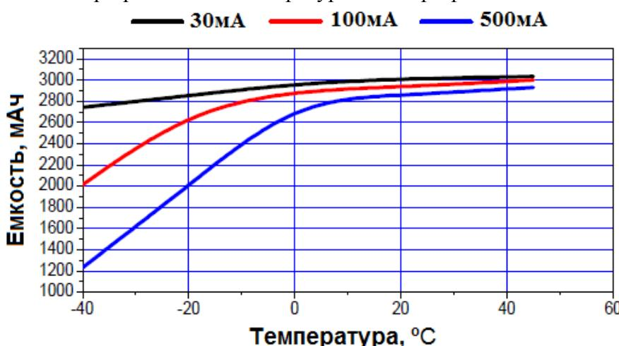
4.2 Напряжение и емкость при различном токе разряда
