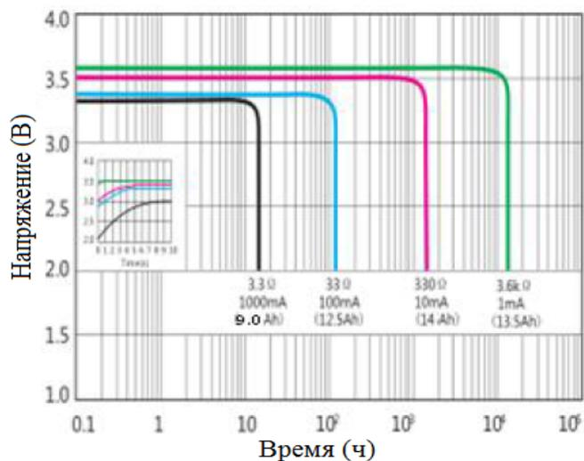
Зависимость напряжения на элементе питания от температуры элемента питания и тока разряда:
